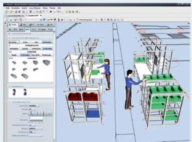
Los distintos puestos de trabajo conforman una línea de producción que observa los aspectos de la producción ajustada
