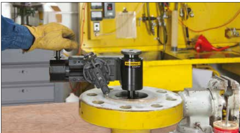
◀ La FF-120 de Enerpac rectificando la brida de un tubo.
