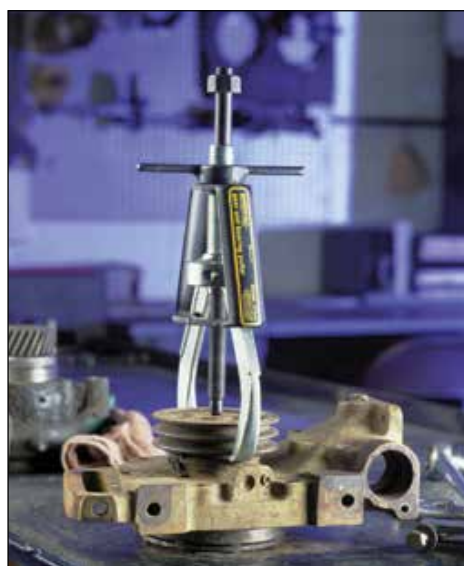
◀ Un extractor de 2 garras EP-204 listo para extraer la polea de una bomba de agua.
