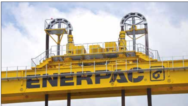
◀ Sistema de gatos de cable HSL85007 utilizado en la torre automontante personalizada.
