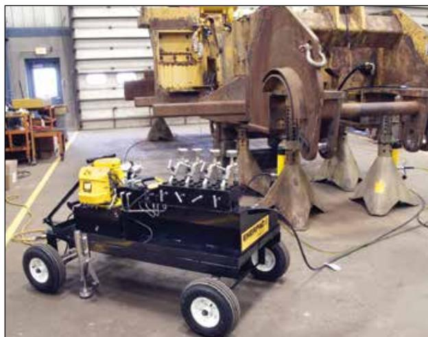
◀ El sistema de levantamiento nivelado ofrece una solución segura de elevación rápida durante la reconstrucción de un vehículo fuera de la autopista.
