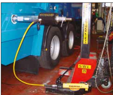
◀ Un cilindro RACH-306 alimentado por una bomba de mano ligera P-392 utilizado para extraer pernos corroidos de vehículos de recogida de basura.
